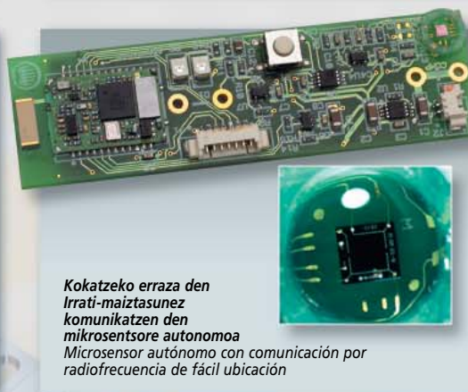
802.11b IKERLAN-IK4ek garatutako txartela sistema komertzial baten txertatua Tarjeta 802.11b desarrollada por IKERLAN-IK4 embebida en un sistema comercial
