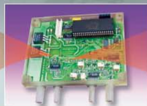
COPRECI-FAGOR-GAS NATURAL Mikrosistema multisentsorea galderentzat Microsistema multisensor-actuador para calderas
