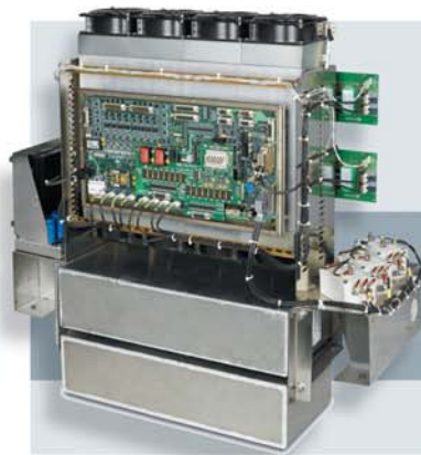
TRINELEC (Grupo CAF) Convertidor de tracción para catenarias de tensión alterna con topología multinivel
